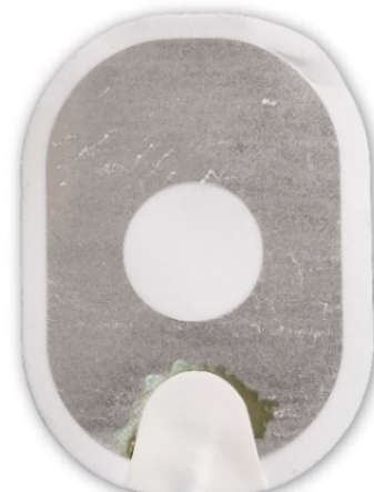
Bild 3: Gel som nästan helt separerats från baksidan.
